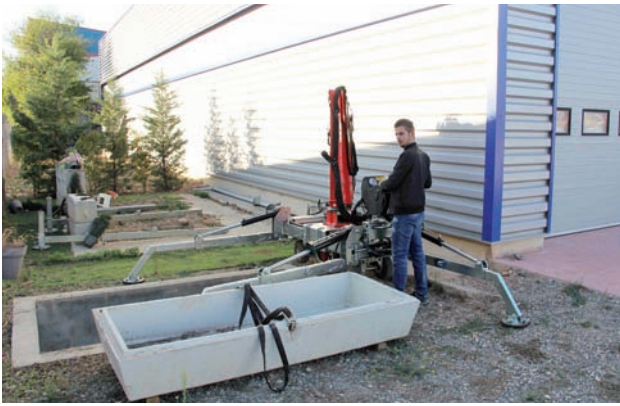
Démonstration à l'usine des possibilités offertes par le tandem chariot/mini-pelle. Vue approchée du chariot libéré du poids de la grue dès que les bras de stabilisation s'appuient sur le sol.
