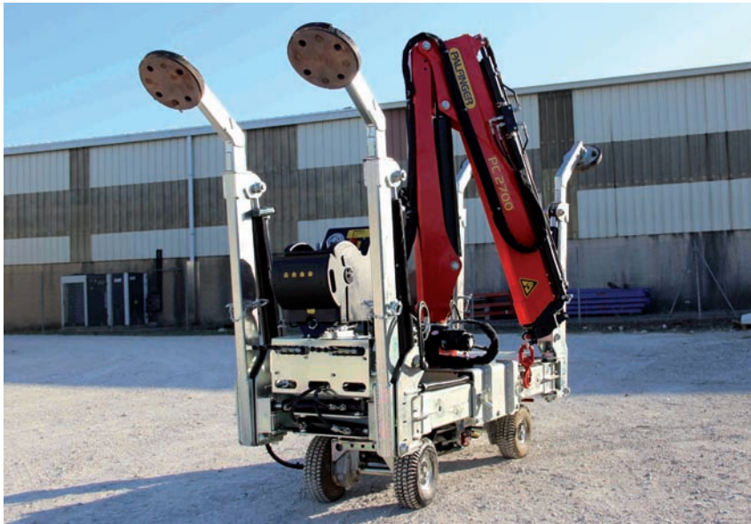
L'ensemble opérationnel mini-pelle sur chariot automotorisé.
