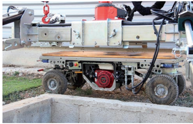
Démonstration à l'usine des possibilités offertes par le tandem chariot/mini-pelle. Vue approchée du chariot libéré du poids de la grue dès que les bras de stabilisation s'appuient sur le sol.
