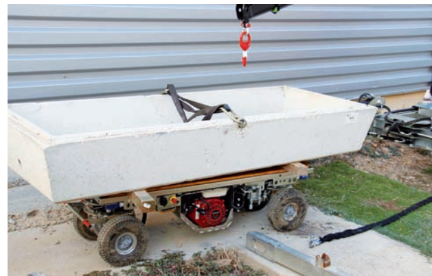
On aperçoit sur la photo du dessus la manipulation des anneaux en ciment, le chariot ayant été dégagé de la mini-pelle pour exécuter d'autres tâches. La mini-pelle, équipée d'une flèche Palfinger, est dotée de tous les accessoires (godets, crochets, ventouses, etc.).
